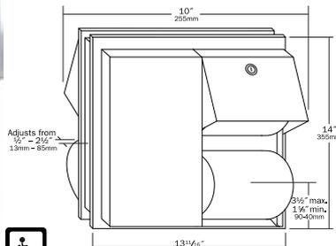
Ouverture de la cloison: 300 x 310 mm
